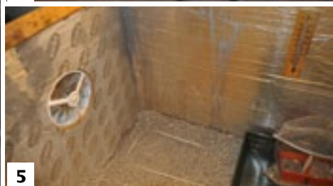
1 · Il primo germinatoio. 2 · rivestimento in polistirolo e cavo scaldante sotto l'argilla espansa. 3 · Scatola del termostato con manopola di regolazione della temperatura. 4 · Il secondo germinatoio. 5 · Interno del secondo germinatoio con carta argentata, termometro, cavo scaldante.
